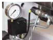
Spanndruckregelung des Spannstocks (Option)
