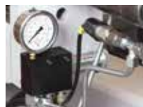
Spanndruckregelung des Spannstocks (Option)
